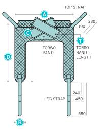
YOKE ATTACHMENT (SPREADER BAR)
